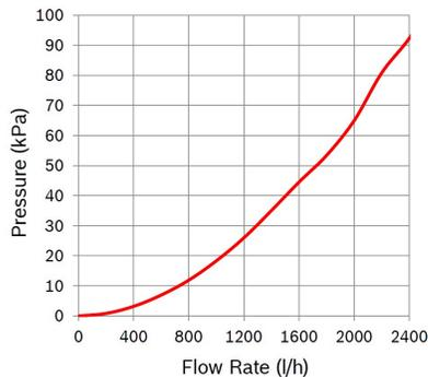
**Tensión nominal (V):** 24**Caída de presión (kPa):** 45**Plazo de entrega (l/h):** 1500**Diferencia de presión conmutable (kPa):** 160**Resistencia ( $\Omega$ ):** 48
