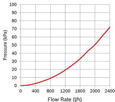
**Tensión nominal (V):** 12**Caída de presión (kPa):** 45**Plazo de entrega (l/h):** 1500**Diferencia de presión conmutable (kPa):** 160**Resistencia ( $\Omega$ ):** 12,4
