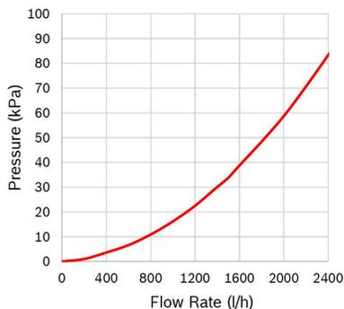
**Tensión nominal (V):** 12**Caída de presión (kPa):** 35**Plazo de entrega (l/h):** 1500**Diferencia de presión conmutable (kPa):** 100**Resistencia ( $\Omega$ ):** 15,3
