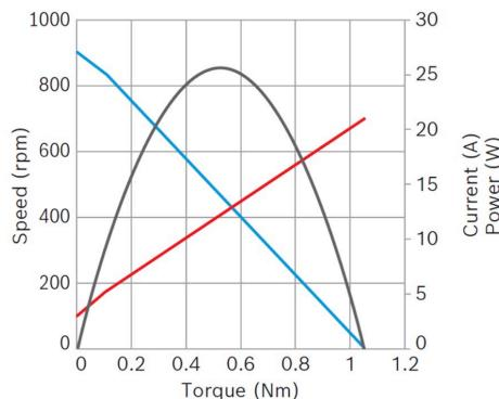
**Potencia nominal (W):** 8,8**Corriente nominal (A):** 5**Velocidad nominal (rpm):** 845**Par nominal (Nm):** 0,1**Par de apriete (Nm):** 1,05**Relación de transmisión:** 27:4**Sensor Hall:** Sí**Posición del reductor:** Izquierda
