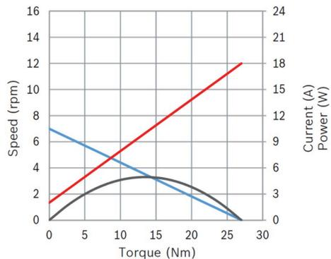
**Potencia nominal (W):** 1,3**Corriente nominal (A):** 4,2**Velocidad nominal (rpm):** 6,4**Par nominal (Nm):** 2**Par de apriete (Nm):** 27,5**Relación de transmisión:** 506:1**Sensor Hall:** Sí**Lado caja de cambios:** Derecha
