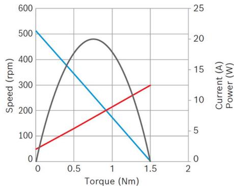
**Potencia nominal (W):** 12,9**Corriente nominal (A):** 4**Velocidad nominal (rpm):** 411**Par nominal (Nm):** 0,3**Par de apriete (Nm):** 1,5**Relación de transmisión:** 27:4**Sensor Hall:** Sí**Lado caja de cambios:** Izquierda
