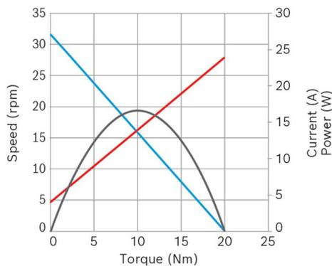
**Potencia nominal (W):** 6**Corriente nominal (A):** 6**Velocidad nominal (rpm):** 28,5**Par nominal (Nm):** 2**Par de apriete (Nm):** 20**Relación de transmisión:** 185,5:1**Sensor Hall:** No**Posición del reductor:** Derecha
