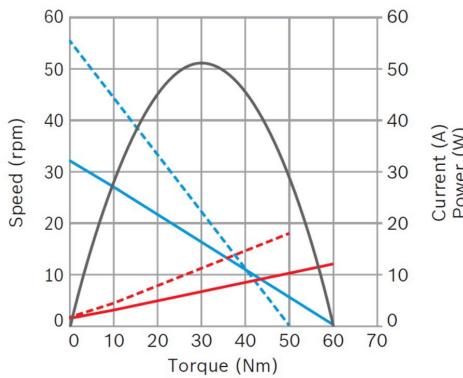
**Potencia nominal (W)\*:** 9,7 / 16,3**Corriente nominal (A)\*:** 1,75 / 2**Velocidad nominal (rpm)\*:** 31 / 52**Par nominal (Nm):** 3**Par de apriete (Nm)\*:** 60 / 50**Relación de transmisión:** 80:2**Sentido de rotación:** en sentido contrario a las agujas del reloj**Sensor Hall:** No**Posición del reductor:** Izquierda
