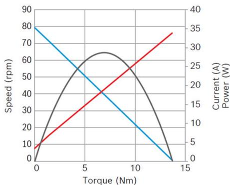
**Potencia nominal (W):** 7,8**Corriente nominal (A):** 6**Velocidad nominal (rpm):** 74,5**Par nominal (Nm):** 1**Par de apriete (Nm):** 13,7**Relación de transmisión:** 73:1**Sensor Hall:** No**Posición del reductor:** Derecha
