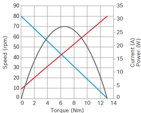
**Potencia nominal (W):** 7,8**Corriente nominal (A):** 6**Velocidad nominal (rpm):** 74,5**Par nominal (Nm):** 1**Par de apriete (Nm):** 13**Relación de transmisión:** 73:1**Sensor Hall:** 2x**Posición del reductor:** Derecha
