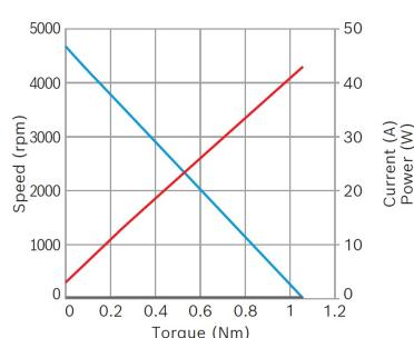
**Potencia nominal (W):** 79,5**Corriente nominal (A):** 11**Velocidad nominal (rpm):** 3800**Par nominal (Nm):** 0,2**Par de apriete (Nm):** 1,05**Sensor Hall:** No
