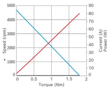
**Potencia nominal (W):** 122,5**Corriente nominal (A):** 115**Velocidad nominal (rpm):** 3900**Par nominal (Nm):** 0,3**Par de apriete (Nm):** 1,8**Sensor Hall:** No
