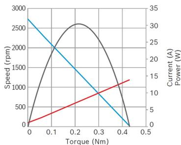
**Potencia nominal (W):** 12,6**Corriente nominal (A):** 2,5**Velocidad nominal (rpm):** 2400**Par nominal (Nm):** 0,05**Par de apriete (Nm):** 0,43**Sensor Hall:** Sí
