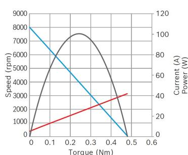
**Potencia nominal (W):** 37,7**Corriente nominal (A):** 9**Velocidad nominal (rpm):** 7200**Par nominal (Nm):** 0,05**Par de apriete (Nm):** 0,43**Sensor Hall:** Sí
