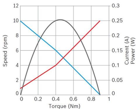
**Potencia nominal (W):** 0,3**Corriente nominal (A):** 0,10**Velocidad nominal (rpm):** 6**Par nominal (Nm):** 0,4**Par de apriete (Nm):** 0,9**Relación de transmisión:** 405:1**Grado de protección:** IP 54**Potenciómetro de señal:** Sí
