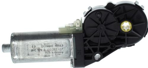
Pour des performances fiables dans un espace réduit : les motoréducteurs compacts Bosch sont la solution appropriée pour les applications industrielles où l'espace est limité. Les entraînements à haute densité de puissance peuvent répondre à de multiples exigences 24V et 12V avec une large gamme de caractéristiques couple/vitesse et d'interfaces mécaniques..
